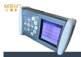
NanoVIP® DGP™ è un potente analizzatore di qualità dell'energia (mono, bi e trifase bilanciato) e un versatile e potente lettore di trasduttori 4..20mA, 0..1V e PT, integrabile in una rete MRH™ tramite il collegamento ad un dispositivo master NANOVIP® QUADRA™.
